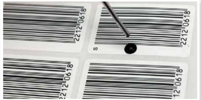
Schritt 1: Tropfen auf Lack mit weißem Hintergrund plazieren Abtupfen! Nicht wischen!
