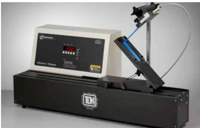
Bild 1: Cheminstruments Verbundkrafttester AR-1000
