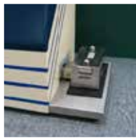
Bild 1+2: Ink Rub Tester (Reibfestigkeitstestgerät für Druckfarben und Lacke)
