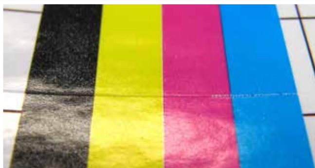
Bild 3: Deformierte Farboberfläche neben angekratzter Farboberfläche
