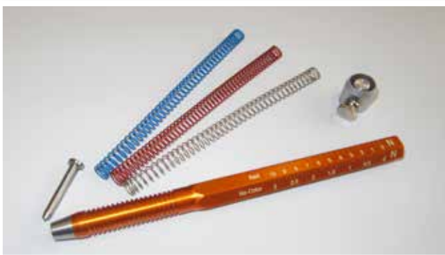
Bild 1: Elcometer 3092 Sclerometer Hardness Tester
