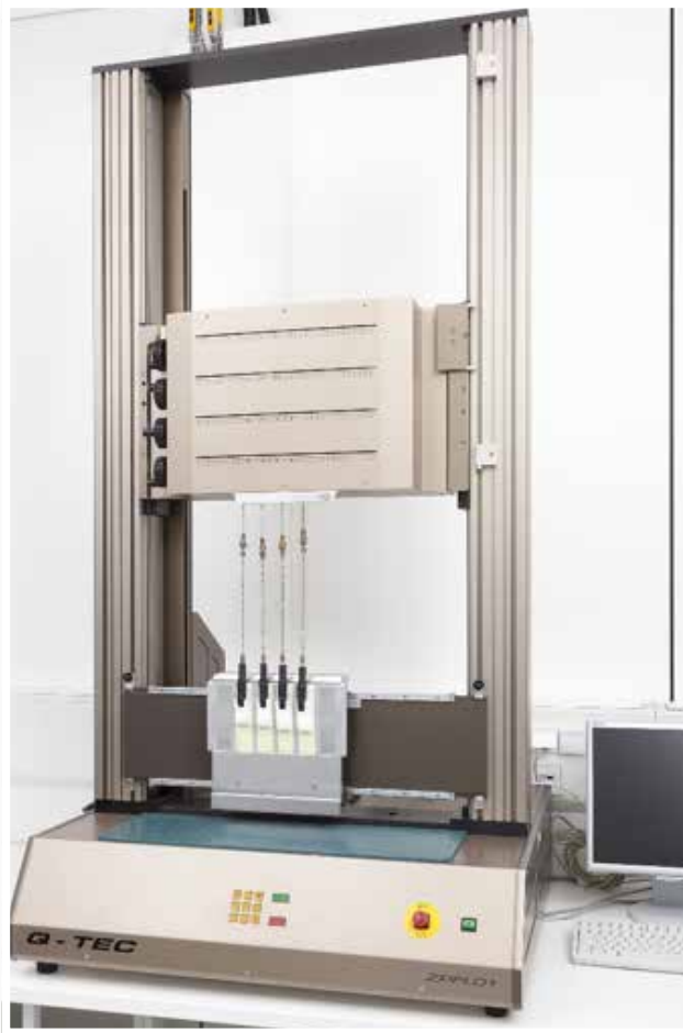
Bild 1: Q-Tec ZPE Abzugtester für geringe Geschwindigkeit
