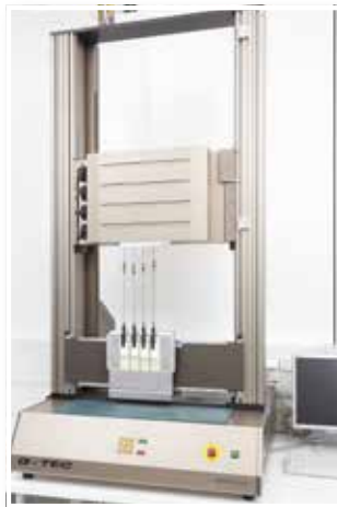
Bild 1: Q-Tec ZPE Abzugstester für geringe Geschwindigkeit
