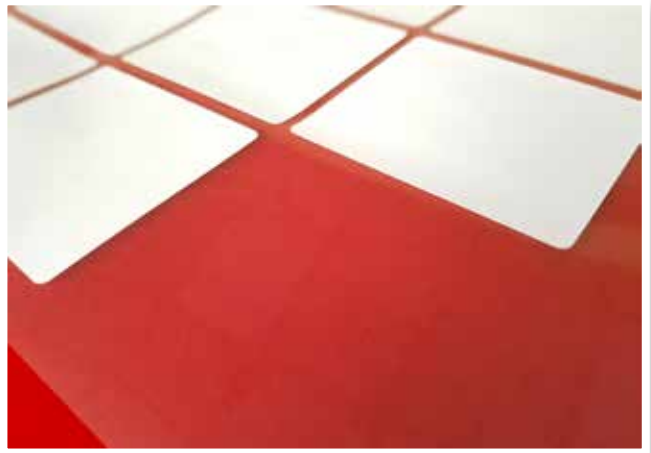
Mit einem perfekten Stanzergebnis auf PET-Trägermaterial ist nur ein messerscharfer Abdruck der Kontur sichtbar.
